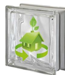
Energy saving staklena opeka razvijena je po principu komora. Sustav karakterizira, komad plutajućeg stakla između dvije staklene stijenske, unutar opeke. Pomoću kojeg su stvorene dvije komore koje punimo plinom argonom. Ova inovativna tehnologija omogućuje znatnu uštedu energije zahvaljujući koeficijentu prolaska topline od 1,5 W/m<sup>2</sup>K.
